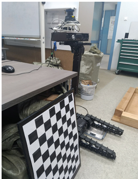
Рис. 4. Двумерный шаблон калибровки в виде шахматной доски
