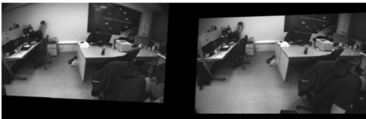
Рис. 7. Кадры, получаемые левой (слева) и правой (справа) камерами СТЗ, составляющими стереопару, после осуществления калибровки стереопары (шаблон №1)
