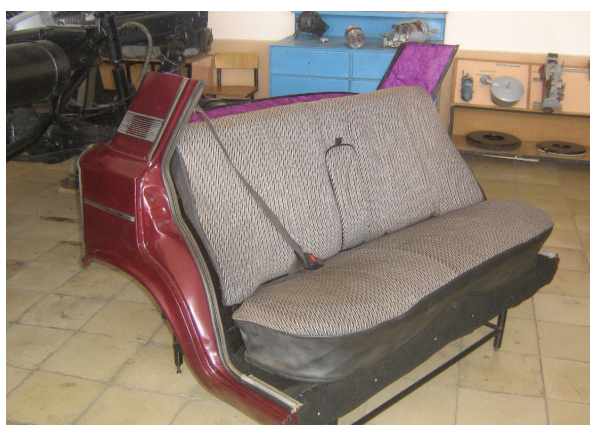
Рис. 6. Стенд для демонстрации и обучения установке ДУУ:
