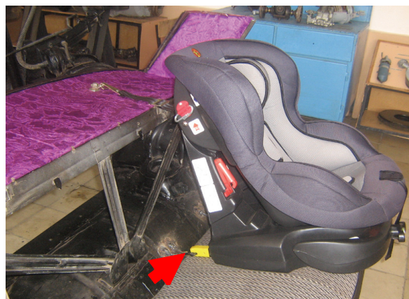
Рис. 5. Крепление ДУУ системой «ISOFIX»
