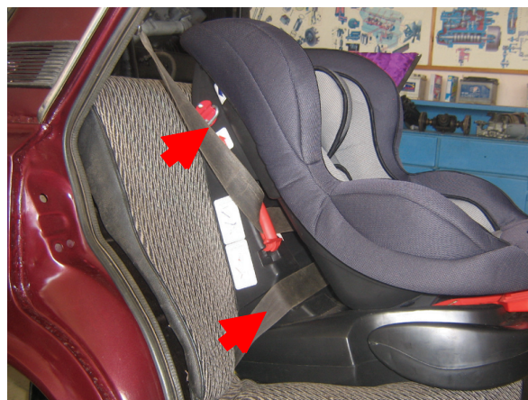
Рис. 4. Крепление ДУУ автомобильным ремнем безопасности
