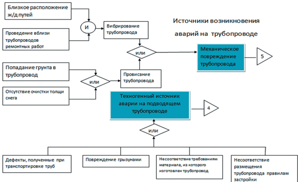
Рис. 5. Древоидная структура взаимосвязи событий на системах водоснабжения Казанской ТЭС-2 (продолжение 3)
