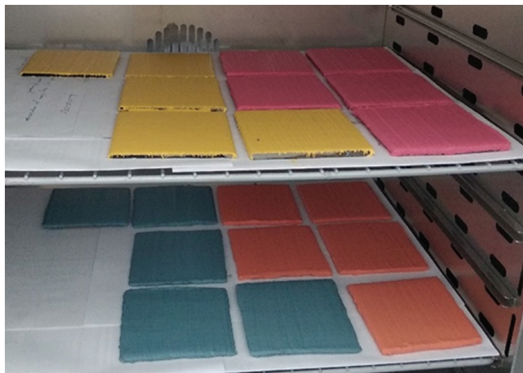
Рис. 2. Вид образцов с нанесенным заколерванным огнезащитным составом
