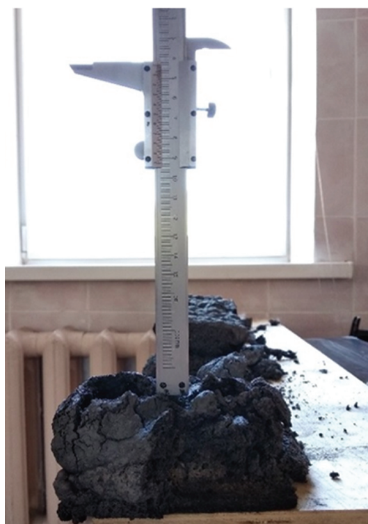
Рис. 3. Измерение толщины шубы вспученного слоя огнезащитного покрытия после теплового тестирования
