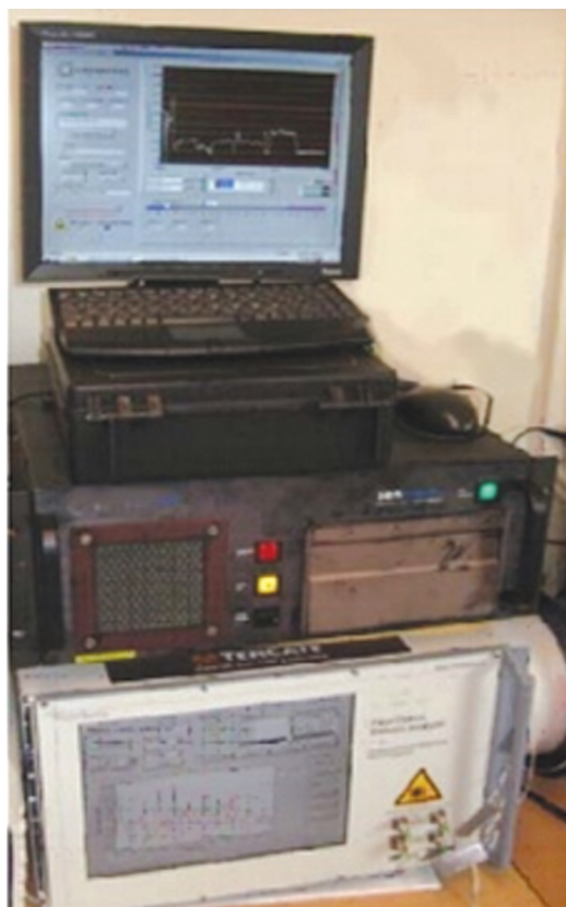
Рис. 2. Рамановская аппаратура для измерения температуры (сверху) и прибор Бриллюэна для измерения деформации (внизу)
