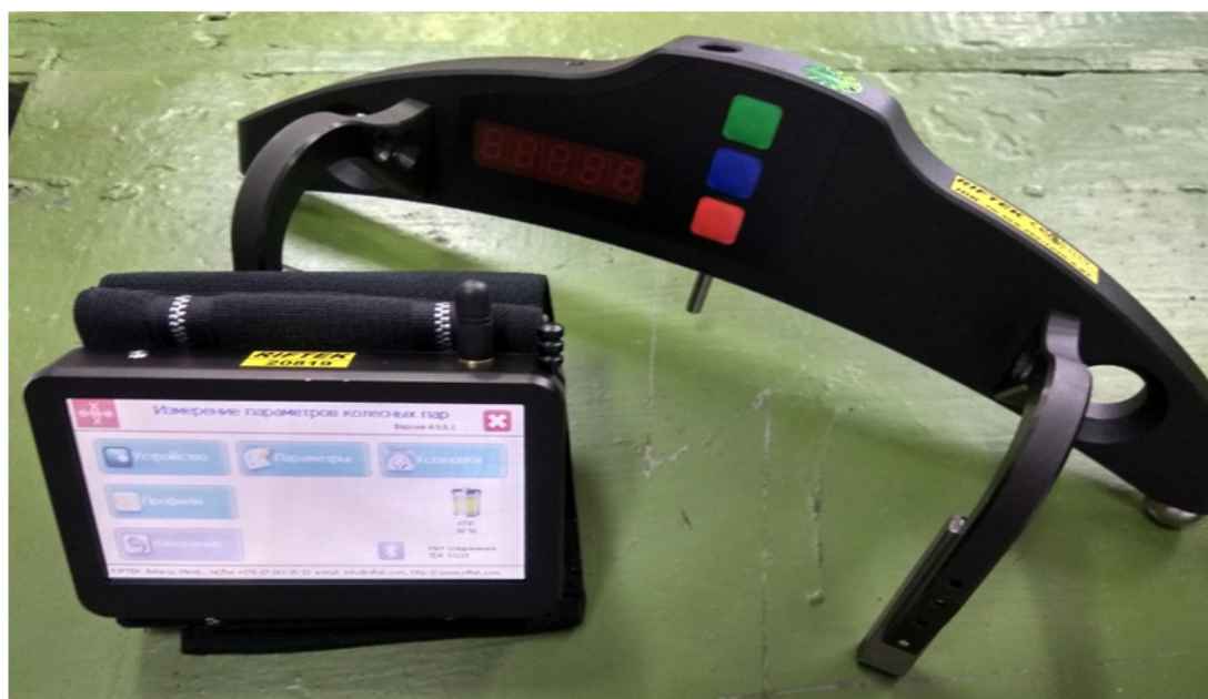
Рис. 4. Комплект оборудования для измерения параметров колёсных пар (шаблон и планшетный пульт с bluetooth-модулем)
