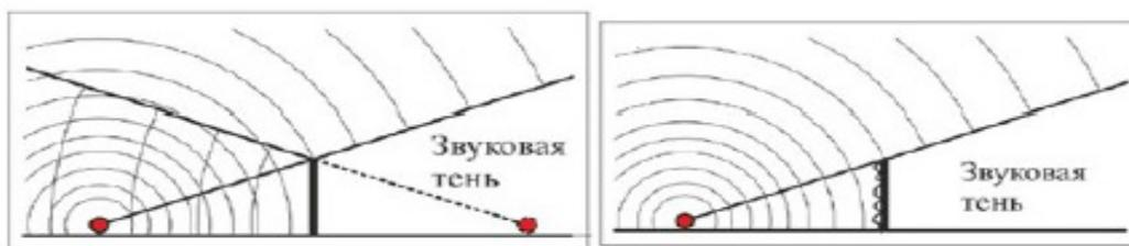
Рис. 2. Схема работы шумозащитного экрана: а – шумоотражение; б – шумопоглощение
