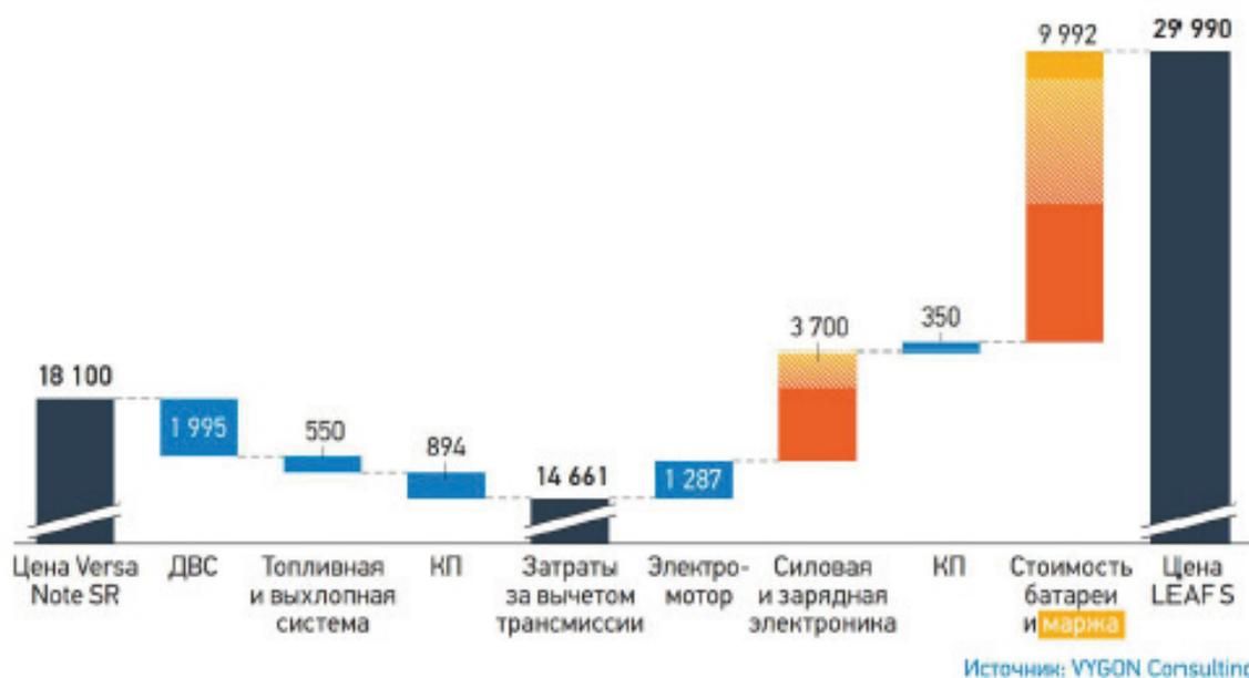
Рис. 2. Структура затрат традиционного автомобиля и электромобиля на примере Nissan Versa Note (ДВС) и LEAF (BEV). USD
