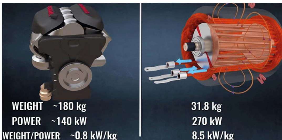
Рис. 3. Характеристики двигателя внутреннего сгорания (слева) и асинхронного тягового двигателя (справа)
