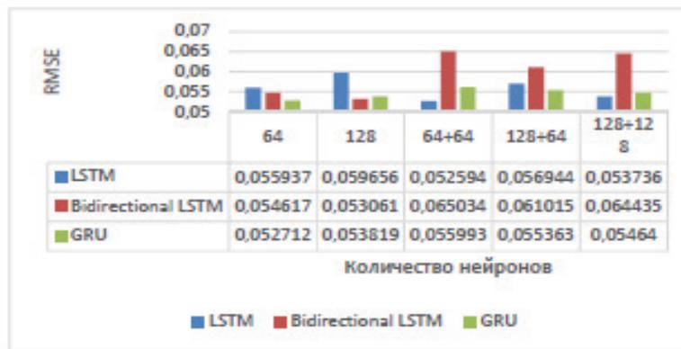
Рис. 8. Оценка точности (RMSE) прогнозирования транспортных потоков в зависимости от архитектуры двунаправленной LSTM (количество входных данных – 12)
