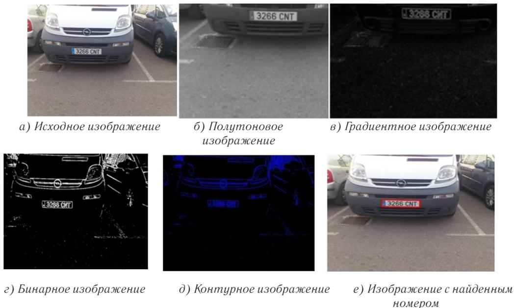
Рис. 1. Обнаружение номера автомобиля методом анализа краев на основе морфологического градиента
