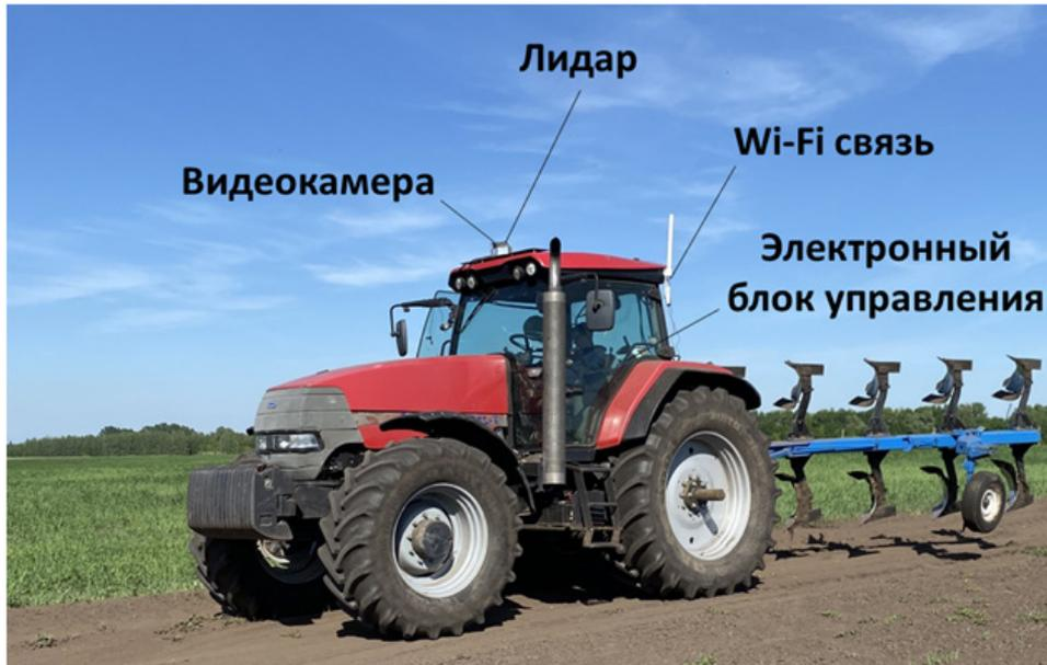
Рис. 4. Комплектация системы автономного управления машинно-тракторным агрегатом
