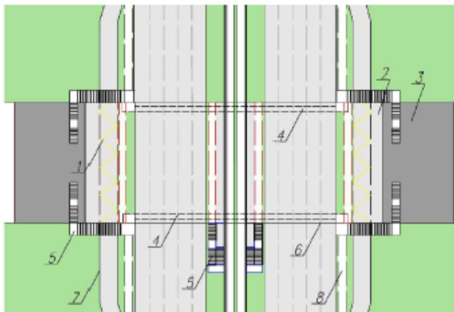
Рис. 6. Схема транспортно-пересадочного узла: 1 – остановочная площадка; 2 – посадочная площадка; 3 – павильон для ожидания общественного транспорта; 4 – расположение пешеходного перехода в разных уровнях; 5 – лестничный сход; 6 – путепровода; 7 – разделительная полоса
