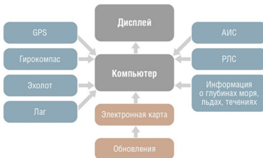
Рис. 2. Структура и принцип работы ЭНК
