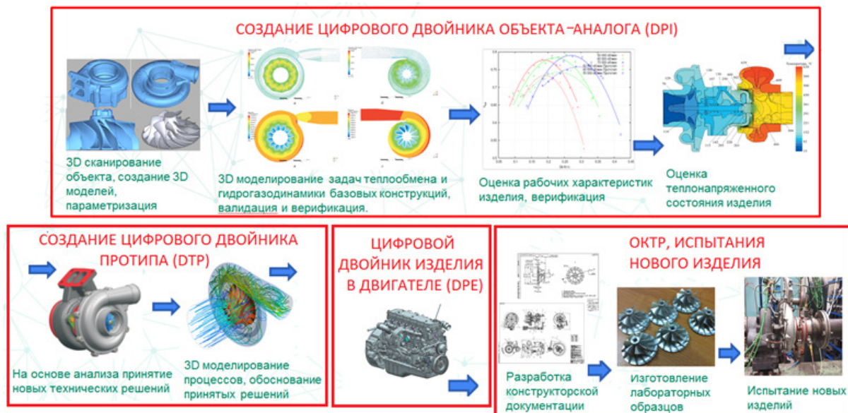
Рис. 4. Схема реализации проекта по разработке цифровых двойников изделия-аналога турбокомпрессора дизельного двигателя и построения на его основе нового изделия с улучшенными характеристиками
