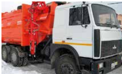
Рис. 66. Грузовой автомобиль-мусоровоз. Объем кузова 7,5 куб. м
