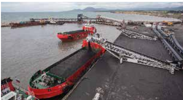
Рис. 100. Грузовой порт Шахтерск на острове Сахалин. Отправка самоходных рейдовых судов с углем для перегрузки в судно-перегружатель
