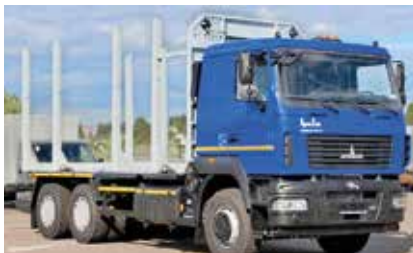
Рис. 65. Грузовой автомобиль со стойками для перевозки длинномерных грузов. Грузоподъемность 14 тонн
