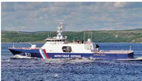
Рис. 93. Пограничный сторожевой корабль «Полярная звезда». Водоизмещение 2700 тонн. Вертолет Ка-27 ПС в ангаре
