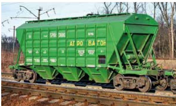
Рис. 76. Вагон-хоппер для минеральных удобрений
