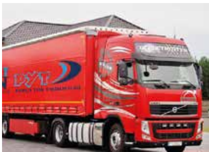
Рис. 61. Грузовой автомобиль-тягач с полуприцепом с тентом. Грузоподъемность до 100 тонн в составе автопоезда
