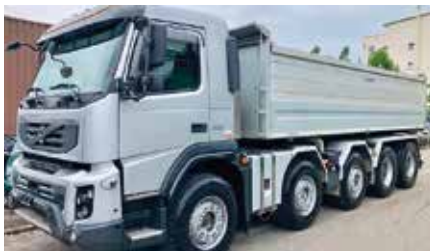
Рис. 67. Грузовой автомобиль самосвал, грузоподъемность 44 тонны
