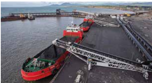
Рис. 99. Погрузка угля ленточными транспортерами в трюм грузового рейдового судна на Сахалине
