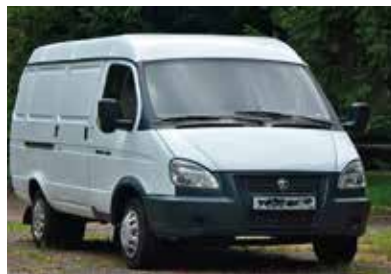
Рис. 64. Грузовой автомобиль («Газель»). Грузоподъемность 1,6 тонны
