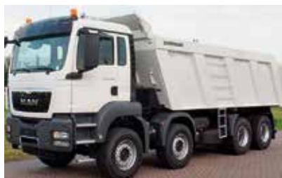
Рис. 68. Грузовой автомобиль-самосвал. Грузоподъемность 20 тонн
