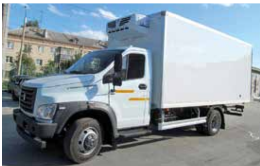
Рис. 72. Грузовой автомобиль с кузовом рефрижератором. Грузоподъемность 3 тонны
