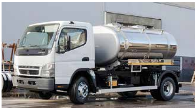
Рис. 73. Грузовой автомобиль-цистерна (молоковоз). Общий объем цистерны – 5000 литров
