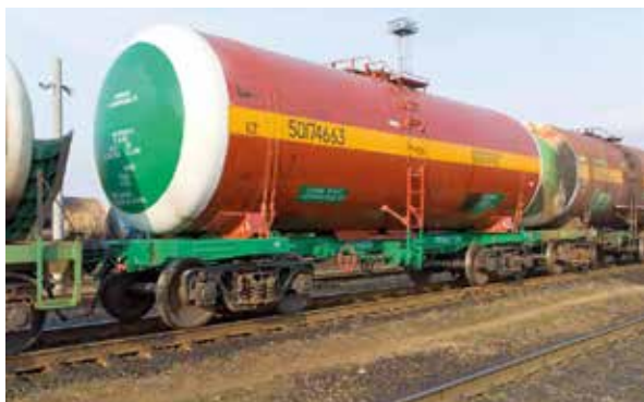
Рис. 80. Вагон-цистерна для бензина, дизтоплива, керосина
