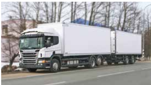
Рис. 71. Грузовой автомобиль с прицепом и изотермическими кузовами
