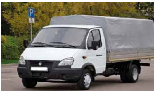
Рис. 69. Грузовой автомобиль – тентованный двухосный. Грузоподъемность 1,5 тонны
