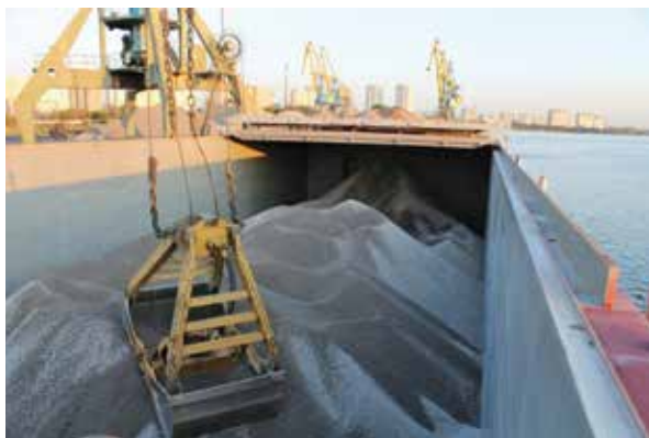
Рис. 98. Погрузка щебня грейфером в трюм балкера
