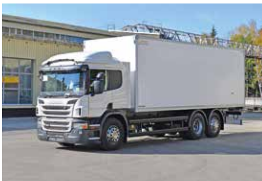
Рис. 70. Грузовой автомобиль. Грузоподъемность 10 тонн с цельнометаллическим кузовом
