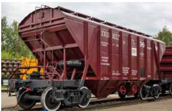
Рис. 75. Вагон-хоппер для цемента
