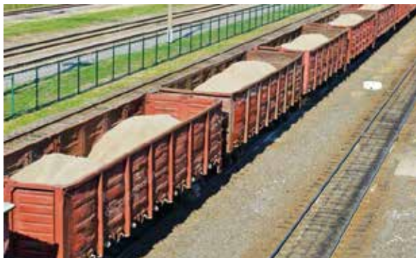
Рис. 81. Состав полувагонов со щебнем
