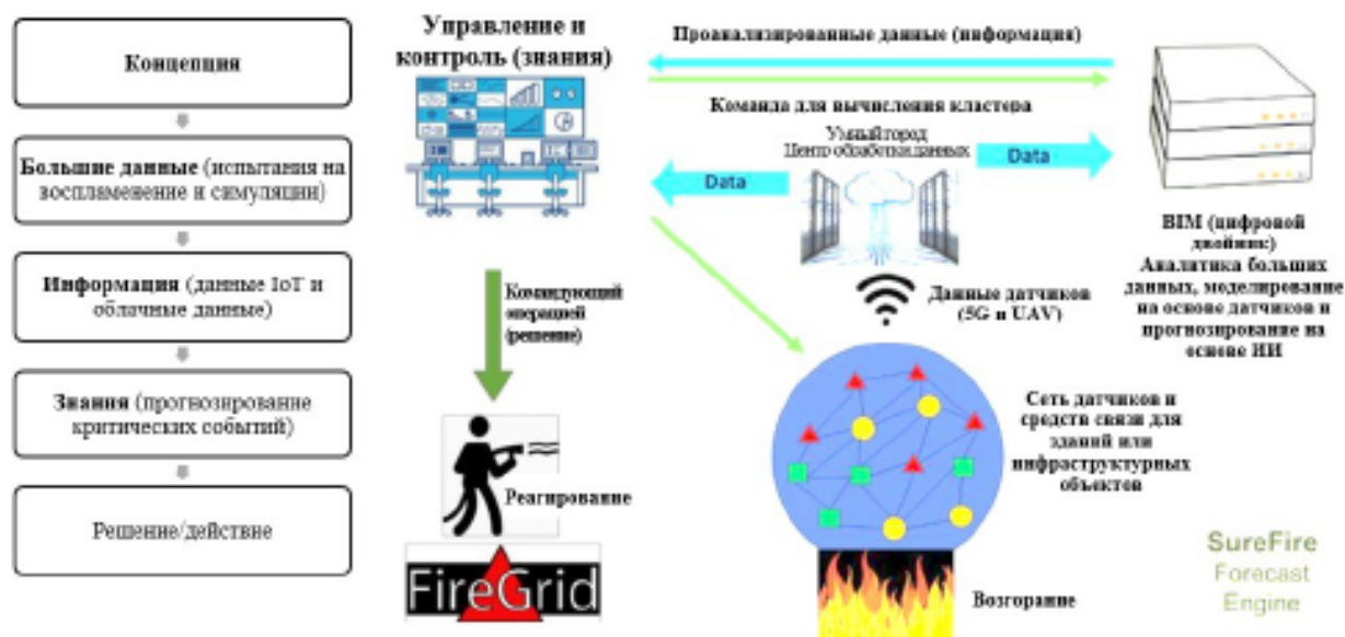
Рис. 2. Концепция механизма прогнозирования SureFire на основе ИИ и сфера применения предлагаемой интеллектуальной системы пожаротушения
