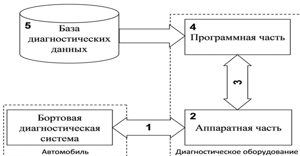
Рис. 1. Структура диагностической системы автомобиля
