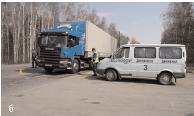
Рис. 3 а, б. Стационарный и передвижной посты весового контроля.
