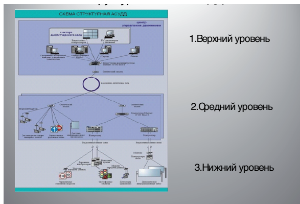
Рис. 6. Структурная схема АСУДД
