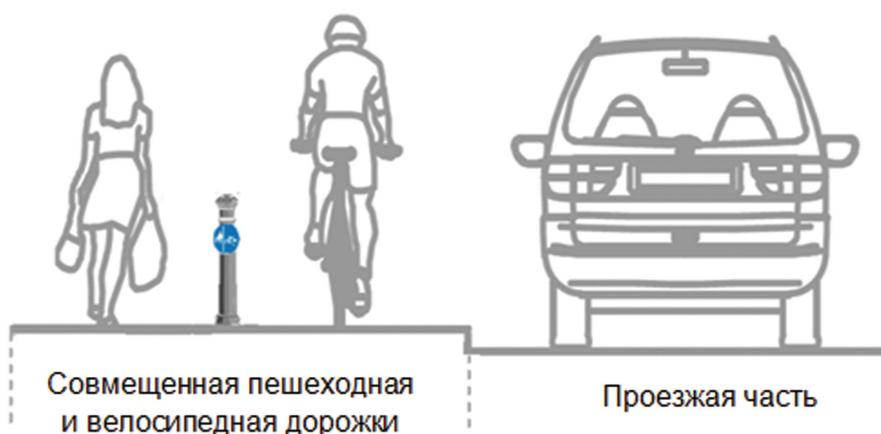
Рис. 3. Поперечное сечение улицы с совместным использованием тротуаров велосипедистами и пешеходами
