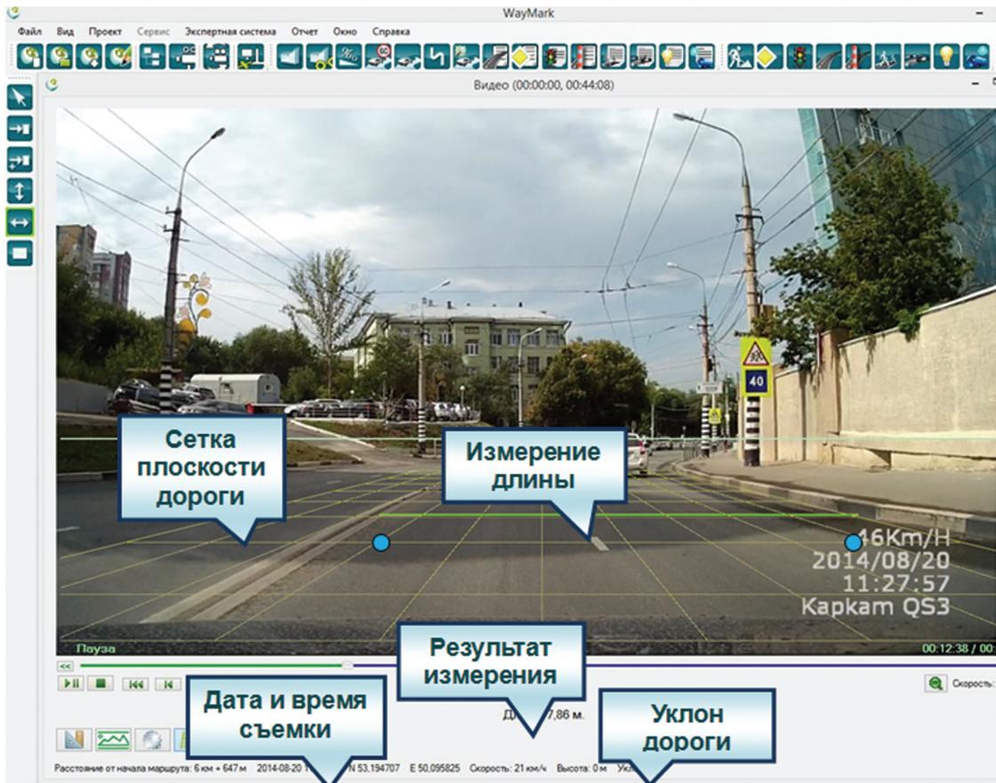
Рис. 6. Измерение по видеокадру в WayMark
