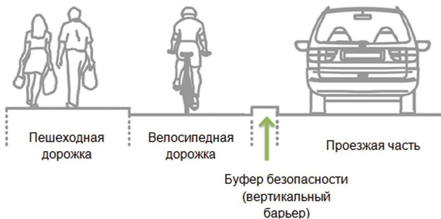
Рис. 2. Поперечное сечение улицы совместно с велосипедной дорожкой в одну сторону
