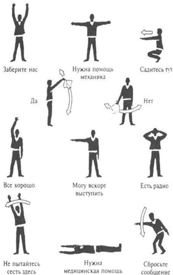
Рис. 1. Сигналы с земли для экипажа спасательного вертолета
