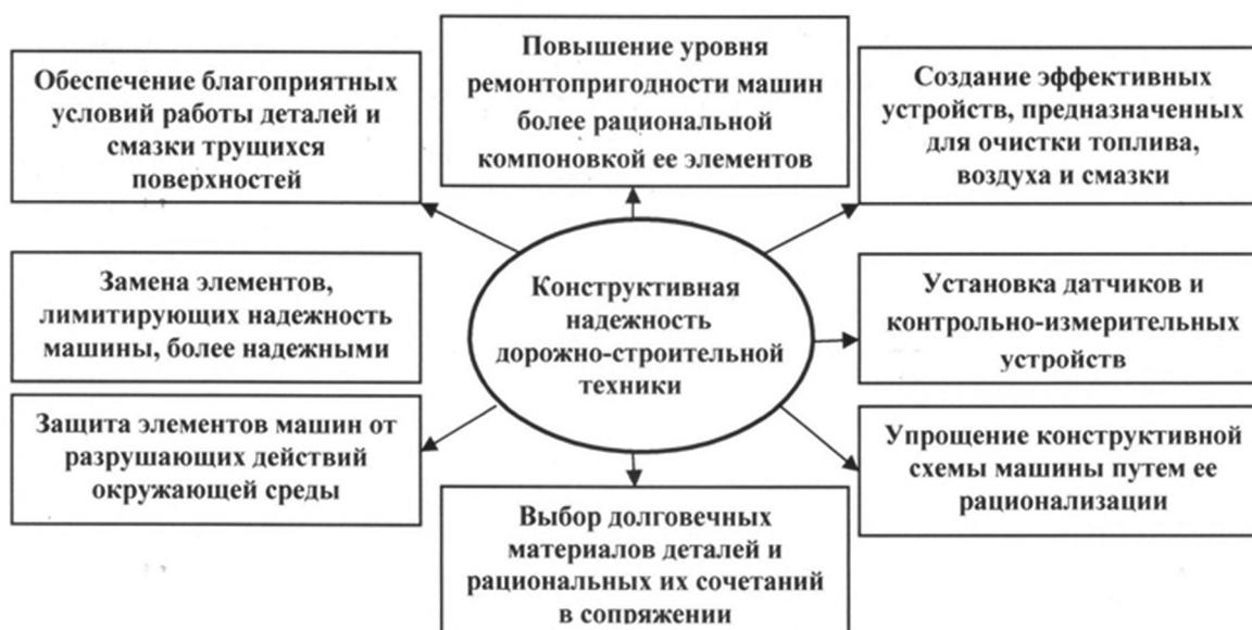
Рис. 1. Конструктивные методы повышения надежности машин
